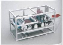
Abb. 3: MiniJet-Anlage zur Wasserstrahlver festigung
