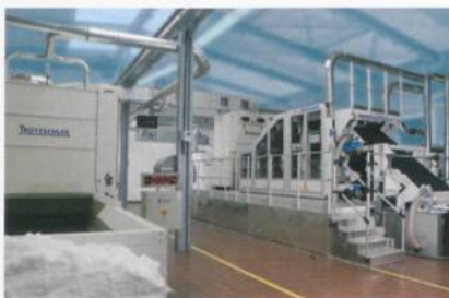
Abb. 1: Das neue Erko-Kardensystem im Fleissner-Technikum
