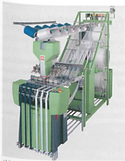
Abb. 1: Gesamtansicht der NH53 6/42
