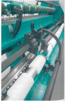
Abb. 1: Frontansicht der Schärmaschine DS 21/30 EC
