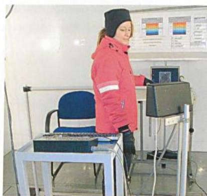
*Mit Hilfe umfangreicher Testreihen mit Probanden wurde die Sensor- und Steuerungstechnik der beheizbaren Handschuhe optimiert, Foto: Hohenstein Institute*
