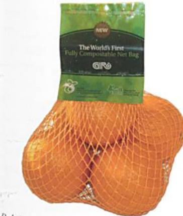
**Polyactid (Biopolymer PLA) Ingeo®, NatureWorks LCC; Verwendung für Bekleidung und Verpackungen, vollwertig kompostierbar**
