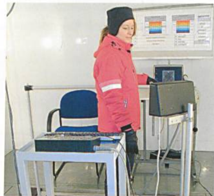
Mit Hilfe umfangreicher Testreihen mit Probanden wurde die Sensor- und Steuerungstechnik der beheizbaren Handschuhe optimiert, Foto: Hohenstein Institute
