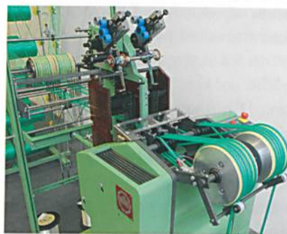
Abb. 1: Die neue Nadelband-Webmaschine für MultiSphere-Produkte NG3M
