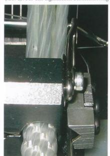
Abb. 3: Seilführung für die Herstellung eines Seils von 7 mm Durchmesser mit Kern
