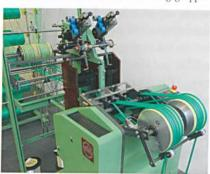
Abb. 1: Die neue Nadelband-Webmaschine für MultiSphere-Produkte NG3M
