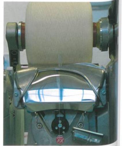
Abb. 7: Individuelles Kantendesign bei Färbespulen für Prozesskettenverkürzung
