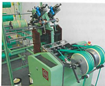
Abb. 1: Die neue Nadelband-Webmaschine für MultiSphere-Produkte NG3M
