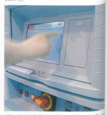
Abb. 6: Einfache und zentrale Einstellung der Spulparameter am Informator
