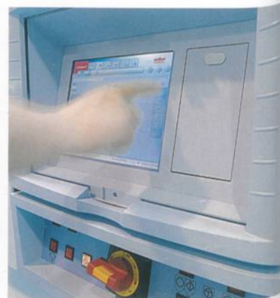
Abb. 6: Einfache und zentrale Einstellung der Spulparameter am Informator
