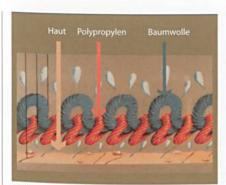
Abb. 1: Beispiel eines zweischichtigen Funktionstextils (Double-Face-Material): Die körpernahe Chemiefaser nimmt den Schweiss auf und leitet ihn an die aussen liegende Baumwolle zur Verdunstung weiter, Quelle: Fa. Löffler
