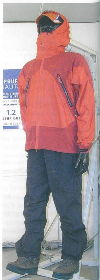
Abb. 5: Mit Hilfe der Gliederpuppe «Charlie» können an den Hohensteiner Instituten auch die Einflüsse der Körperbewegungen, der Umgebungstemperatur und des Kleidungschnittes auf den Tragekomfort gemessen werden
