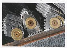
Abb. 5: Schützen mit garngefüllten Bobinen
