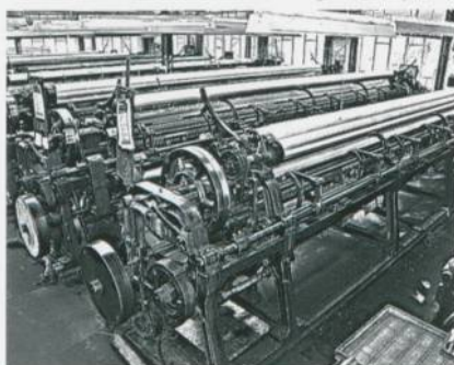
Abb. 1: Bobinet-Maschinen, erfunden von John Heathcoat im Jahre 1808
