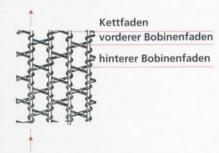
Abb. 2: Schema der Bindungstechnik für ungemusterte (glatte) Bobinet-Tülle
