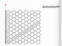
Abb. 3: Bestimmung der Tüllfeinheit
