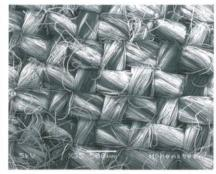
Gewebe aus 100% Stapelfasergarn nach 100 Waschzyklen: Die Stapelfasern im Mischgarn weisen eine bohe mechanische Belastbarkeit auf
