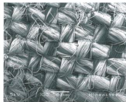
Gewebe aus 100 % Stapelfasergarn nach 100 Waschzyklen: Die Stapelfasern im Mischgarn weisen eine hohe mechanische Belastbarkeit auf
