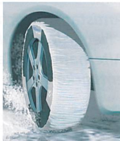
Abb. 2: RUDmatic Soft Spike: Patentierter Reifenüberzug auf Textilbasis (Foto: RUD PR)
