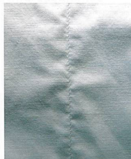
Abb. 4: Gekräuselte Nahtoptik nach der Wäsche durch zu hohe Fadenzugkräfte
