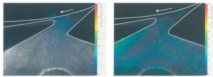
Abb. 5: Ergebnisse der Strömungsmessungen mit PIV am praktischen Modell ohne (links) und mit (rechts) Besaugung der Ausscheidestelle
