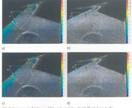
Abb. 7: Gemessene Luftströmungsfelder mit möglichen Partikelflugbahnen (gelb)
