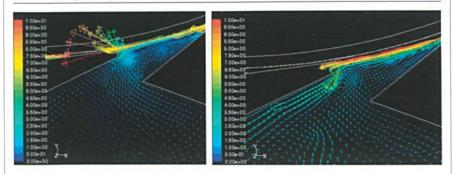
Abb. 3: Berechnete Vektorbilder der Luftströmung ohne (links) und mit (rechts) Besaugung des Ausscheidebereichs
