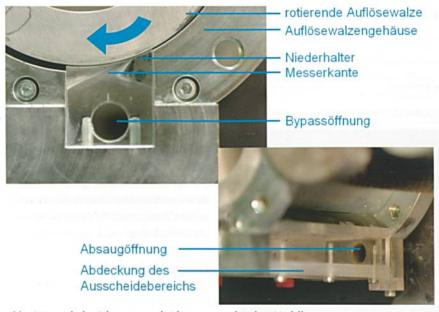
Abb. 4: Bereich der Schmutzausscheidung am praktischen Modell
