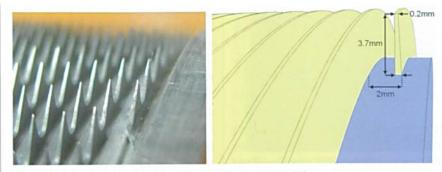
Abb. 2: Vereinfachung der Garniturzähne im Simulationsmodell
