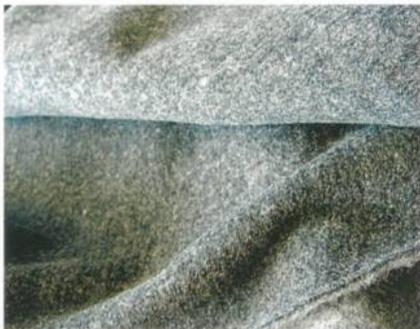
Abb. 2: Schwer entflammbarer Maschenstoff, «Qualität e2»
