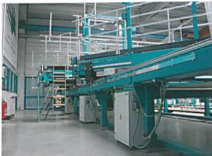
Abb. 3: Segmentierung des Schusseintragsgestells und der Schusslegersysteme mit je einem Schaltschrank
