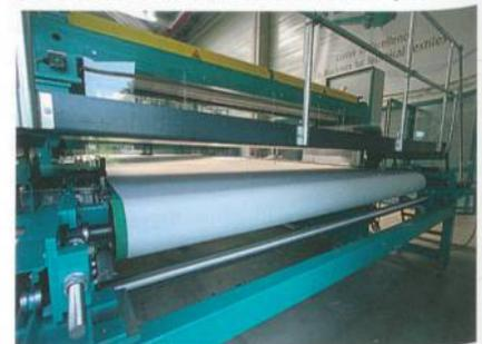
Abb. 1: Durchgängige Transportauflage am Eingang der Maschine
