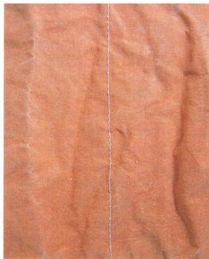
Abb. 1: Unakzeptable Nahtoptik nach der Wäsche (keine Bewertung nach dem Qualitätsstandard 702 möglich)
