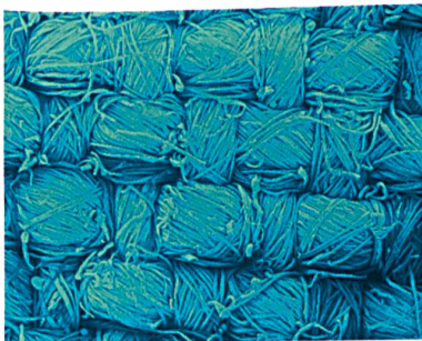
Abb. 1: Gewebe mit kritischen Faserenden
