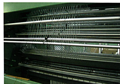
Abb. 1: GWM 1200 RR Kettenwirkmaschine
