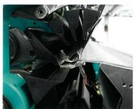
Abb.3: Wirkwerkzeuge der HKS 3-M mit Poleinrichtung
