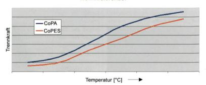
Abb. 2: Vergleich des Trennkraftverlaufes
