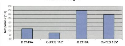
Abb. 1: Vergleich der Wärmestandfestigkeit
