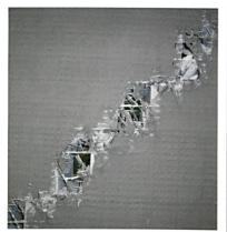
Nabaufnahme des Mauersegments – die vertikalen Mauerfugen klaffen mebrere cm auseinander – das textile Gitter verbindert den Einsturz der Mauer
