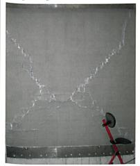
Mauersegment nach dem Erdbeben-Test
