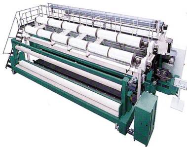
Abb. 4: Modell aus der Serie der Raschelmaschinen mit Schusseintrag
