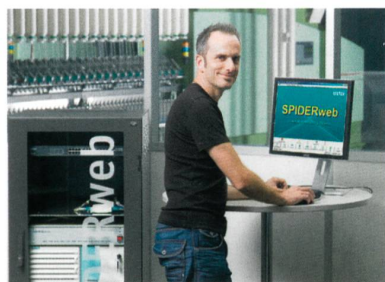
Abb. 10: Das Datenerfassungssystem SPIDERweb ermöglicht die Überwachung und in Folge die systematische Optimierung der Produktivität und Qualität in Spinnereien
