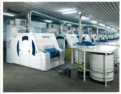
Abb. 1: Die neue Trützschler Hochleistungskarde TC 07
