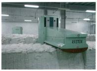
Abb. 1: Der automatische Ballenöffner UNI-
