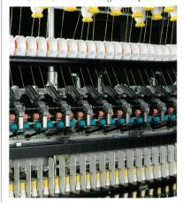
Abb. 7: Das Ringspinn-Coregarnsystem von Rieter
