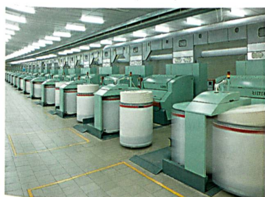
Abb. 2: Die Karde C 60 mit der revolutionären Arbeitsbreite von 1'500 mm
