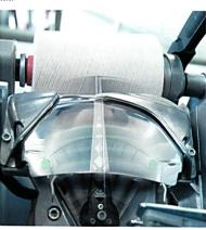
Abb. 2: Das neue trommellose Fadenverlegesystem Preci FX
