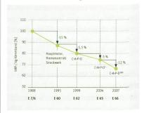
Abb. 3: Energieeinsparung mit Rieter-Kämm maschinen seit 1988
