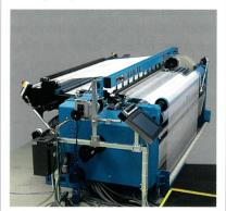
Abb. 1: Luftdüsenwebmaschine COMBINE
