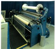
Abb. 2: Wasserdüsenwebmaschine CAMEL W
