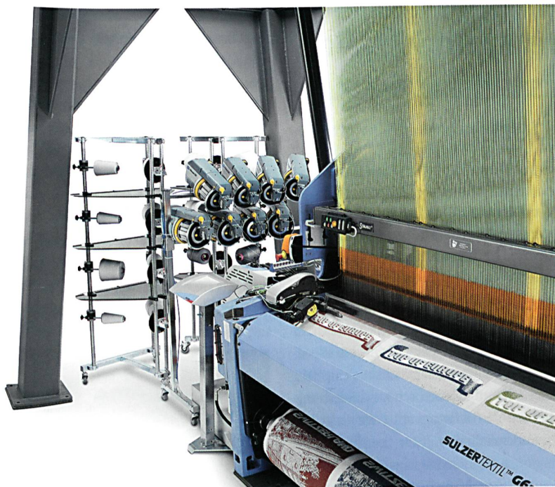
Abb. 2: Die Sulzer Textil Greiferwebmaschine 6500F ist die Frottierwebmaschine, die höchsten Ansprüchen bezüglich Gewebequalität und Leistung gerecht wird
