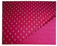
Abb. 2: Spacerknit mit Checkmuster und bydrophobem Finish
