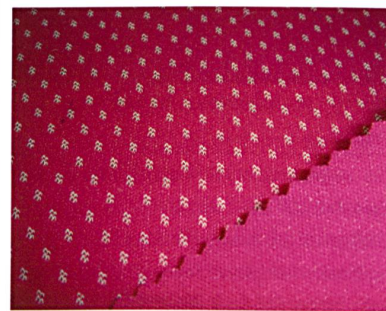
Abb. 2: Spacerknit mit Checkmuster und hydrophobem Finish
