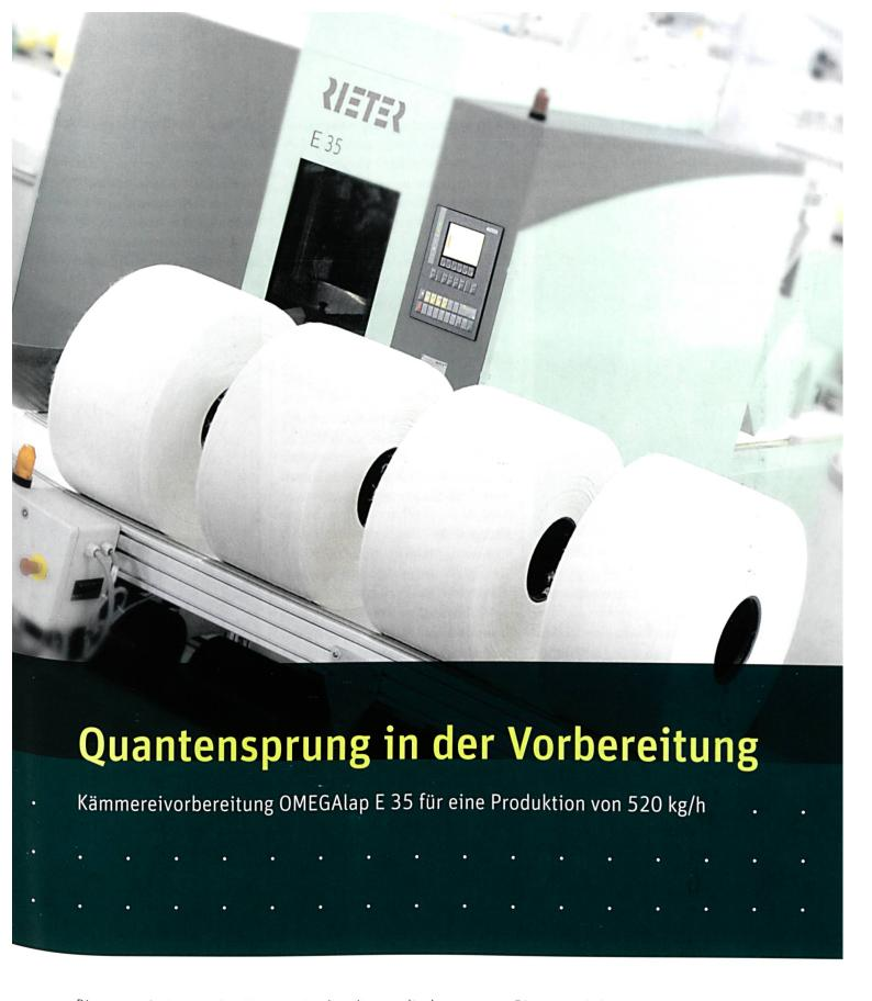
Rieter revolutioniert die Kämmereivorbereitung mit einem neuen Riemenwickelsystem. OMEGAlap E 35 ermöglicht Wickelgeschwindigkeiten bis zu 180 m/min und Produktionsleistungen bis 520 kg/h – dank vollumfänglicher, omega-förmiger Wattenführung und Druckverteilung durch den Wickelriemen. Das neue Rieter Kämmerei-Set mit 1 Vorbereitungsmaschine OMEGAlap E 35 und 6 Kämmmaschinen E 66 bzw. E 76 produziert bis zu 10 Tonnen Kämmband pro Tag.
