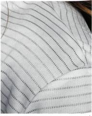
Abb. 3: Ein antistatisches und antibakterielles T-Shirt, das mit Silber beschichtete Fasern enthält
