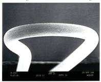
Abb. 2: Eine silberbeschichtete Textilfaser unter dem Elektronenmikroskop
