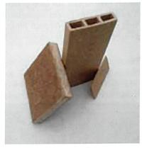
Abb. 3: Formteile aus Hanffasern
