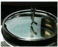
Vollautomatische Reihen-Benetzungsmessung von Einzelfasern
