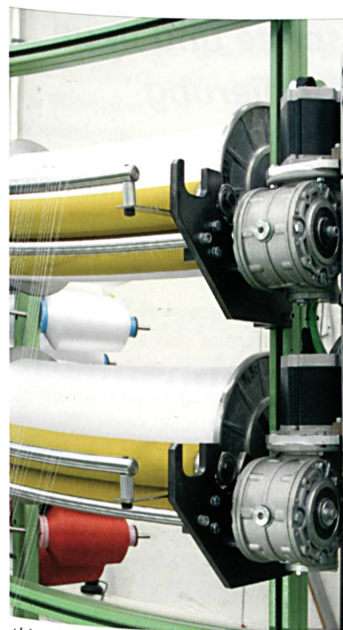
Abb. 6: Geregelte Zuführung von Kant- und Ripsfäden
