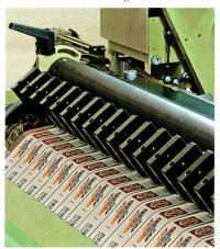
Abb. 10: Schneideelemente TVI2 für die Herstellung hautfreundlicher Etikettenkanten
