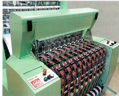
Abb. 3: Die Nadelbandwebmaschine MDLM 95
