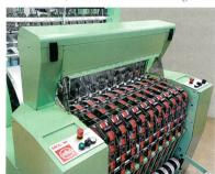
Abb. 3: Die Nadelbandwebmaschine MDLM
