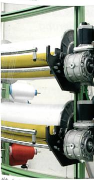
Abb. 6: Geregelte Zufübrung von Kant- und Ripsfäden
