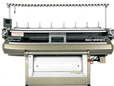
Abb. 1: Die konventionelle Flachstrickmaschine SIG 123 SV
