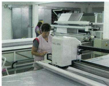
Abb. 2: automatischer Cutter
