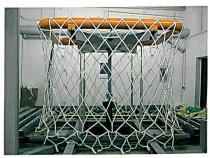
Prüfung eines Luftfracht-Sicherungsnetzes
