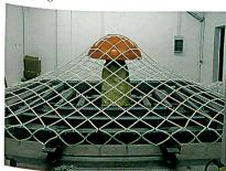
Prüfung eines aufgespannten Sicherungsnetzes mit Halbkugel-Prüfkörper
