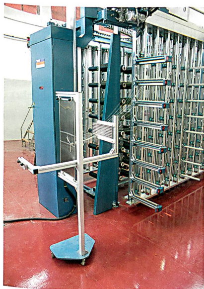
Abb. 5: Rüstwagen für Fadenführung, Gelese- und Schärblatt
