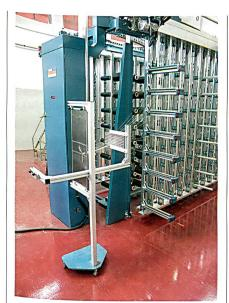
Abb. 5: Rüstwagen für Fadenführung, Gelese- und Schärblatt
