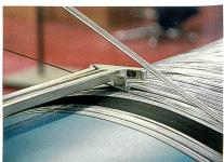
Abb. 4: Optische Positionsprüfung der Teilungsschieber
