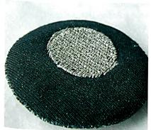
Die textile Elektrode aus mit Silber beschichteten Garnen ermöglicht Langzeit-EKG-Messungen
