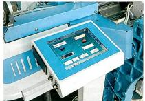
Abb. 7: Touch-Screen an der Maschinenreihe 920 von SMIT
