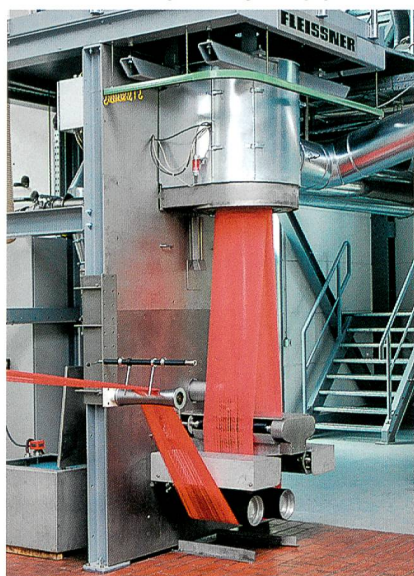
Abb. 2: Kompakt-Spinnposition im Fleissner Technikum
