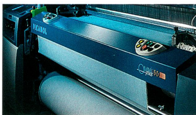
Abb. 4: Luftdüsenwebmaschine OMNIplus 800 4-P 190
