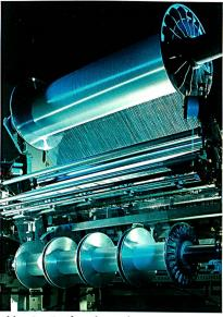
Abb. 2: Greiferwebmaschine OptiMax 6-R 220
