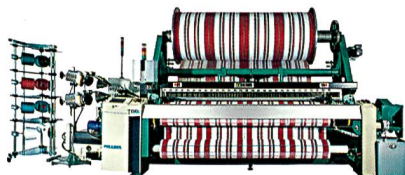
Abb. 5: Frottier-Luftdüsenwebmaschine TERRYplus 800 8-J 260
