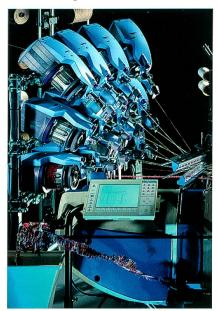
Abb. 3: Greiferwebmaschine OptiMax 8-R 340
