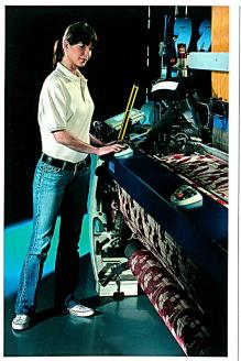
Abb. 1: Greiferwebmaschine OptiMax 8-R 190
