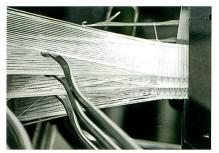
Abb. 9: Webstelle; sichtbar die drei Kettlagen, die zu einem Band verwoben werden
