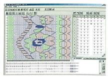
Abb. 2: MÜCARD2 – Screenshot mit Legungsbereich, Kettengliederanordnung und Einzugsschema
