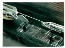
Abb. 5: Positiver Greifer für variable Garne
