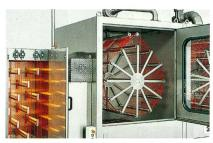
Abb. 11: SPIDER K – kontinuierlich arbeitende singleend Färbe- und Appretiermaschine
