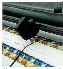
Abb. 4: TVT-Trennmesser für geschnittene Etiketten mit samtweichen Kanten
