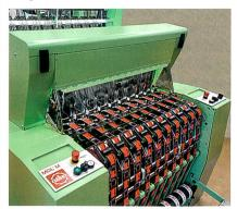
Abb. 3: MDLM – harnischlose Webmaschine für jacquardgemusterte Etiketten
