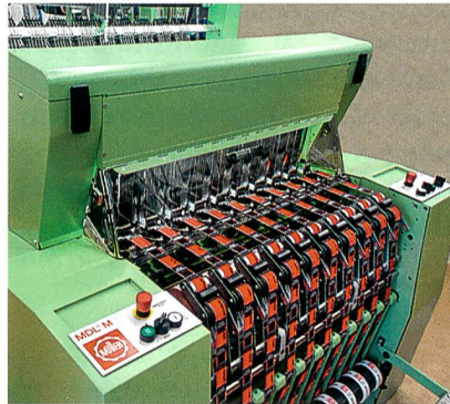
Abb. 3: MDLM – harnischlose Webmaschine für jacquardgemusterte Etiketten
