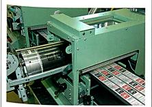
Abb. 6: Bedrucken textiler Bänder im «Print on Demand»-Verfabren
