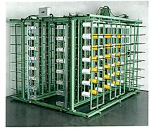
Abb. 8: MÜCREEL – Spulengatter mit Drehrahmen und zentraler Fadenzugkraftverstellung
