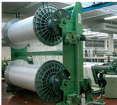
Abb. 2: Separates Kettbaumgestell, 2-bäumig für Förderbandgewebe
