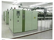
Abb. 17: Rotorspinnmaschine BT 923
