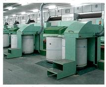
Abb. 1: Karde C 60 mit dem neuen SB-Modul
