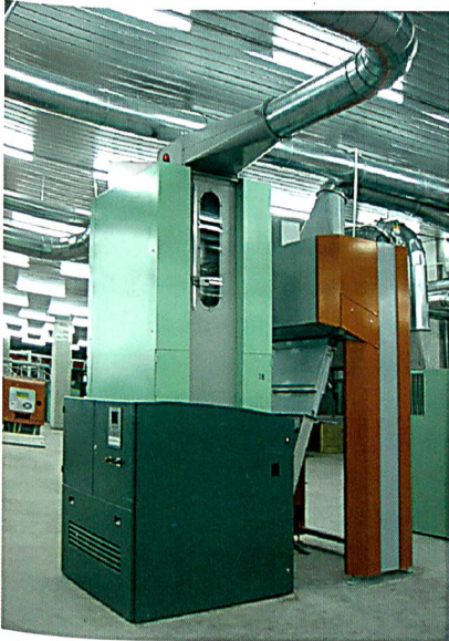
Abb. 6: Speicher- und Speiseeinheit UNIstore A 78
