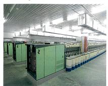
Abb. 16: Rotorspinnmaschine R 40
