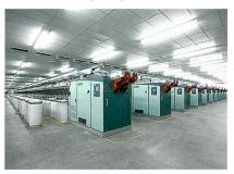
Abb. 3: Rotorspinnmaschine R 40 mit AEROpiecing®
