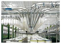
Abb. 15: Vorgarnspulen-Transportsystem SERVOtrail
