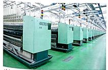
Abb. 1: Ringspinnmaschine G 35
