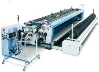
Sulzer Textil Projektilwebmaschine P7300HP in Spezialausführung in einer Arbeitsbreite von 5,4 Metern. Die Maschine ist mit einer PowerLeno Halbdrehereinrichtung ausgestattet für die Herstellung von Zweitrücken für Teppichgrundgewebe oder technischen Produkten für die Agro- und Bauindustrie.
