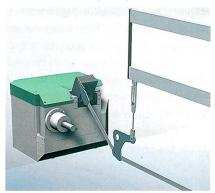
Abb. 1: Neue Fachbildeeinrichtung. Die Selektion erfolgt während der Bewegung und nicht im Stillstand
