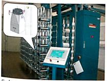
Fadenzugkraftregelung mit MULTITENS
