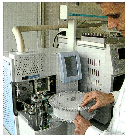
Qualitativer und quantitativer Nachweis von Geruchssubstanzen auf Textilien mittels Gaschromatograph mit Massenspektrometer
