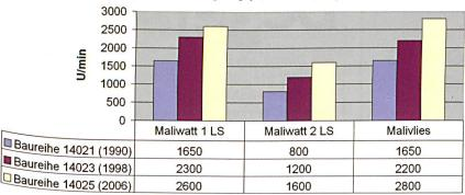
Abb. 6: Entwicklung der max. Drehzahl der Nähwirkmaschinenmodelle 14021/14023/14025
