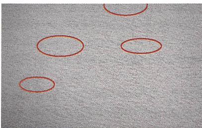
Abb. 2a: Mit Fremdfasern markierte Ansetzer; single jersey – Rechts-Link-Gestrick NeC 28 100 % CO, Tageslicht
