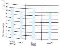
Abb. 1: Vergleich der Faserfestigkeiten von Lenzing Lyocell, Tencel, Zimmer Lyocell sowie SeaCell®-pure
