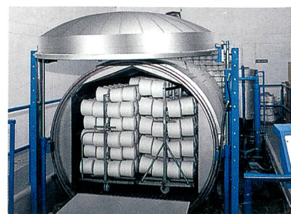
Abb. 2: Seit die Vardhman-Gruppe Garn konditioniert, wurde eng mit XORELLA zusammengearbeitet, dem Entwickler und Marktführer dieser Technologie. «Jedes Garn muss konditioniert werden, sonst gibt es Probleme», sagt S.P. Oswal. «Das indische Klima ermöglicht keinen Rückbehalt von Feuchtigkeit im Garn, es ist zu heiss.» Bild: Xorella AG, Wettingen (CH)
