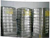
Abb. 3: 99% aller Garne werden konditioniert, ausser Polyester- und Acrylgarne. Nach dem Konditionieren werden die Garne sofort in Folien verpackt und geben zur Weiterverarbeitung. Bild: Xorella AG, Wettingen (CH) «Kubische Maschinen bieten vor allem Vorteile in rationelleren Arbeitsabläufen», erklärt S.P. Oswal dazu. «Wir können mit ganzen Paletten einfahren, und das erspart uns viel manuelle Arbeit in der Vorbereitung zum Dämpfen und beim Entladen für die nachgelagerten Stufen.»
